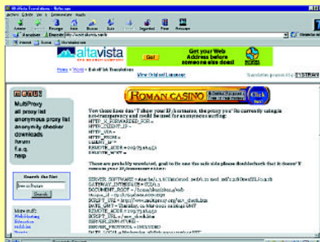
Figura 1: Comprobación del anonimato obtenido por el motor traductor de Altavista. La dirección IP mostrada en el campo REMOTE_ADDR pertenece a una máquina de Altavista, así como el resto de los campos, permitiendo, por tanto, que un usuario abuse de este servicio para navegar anónimamente.
